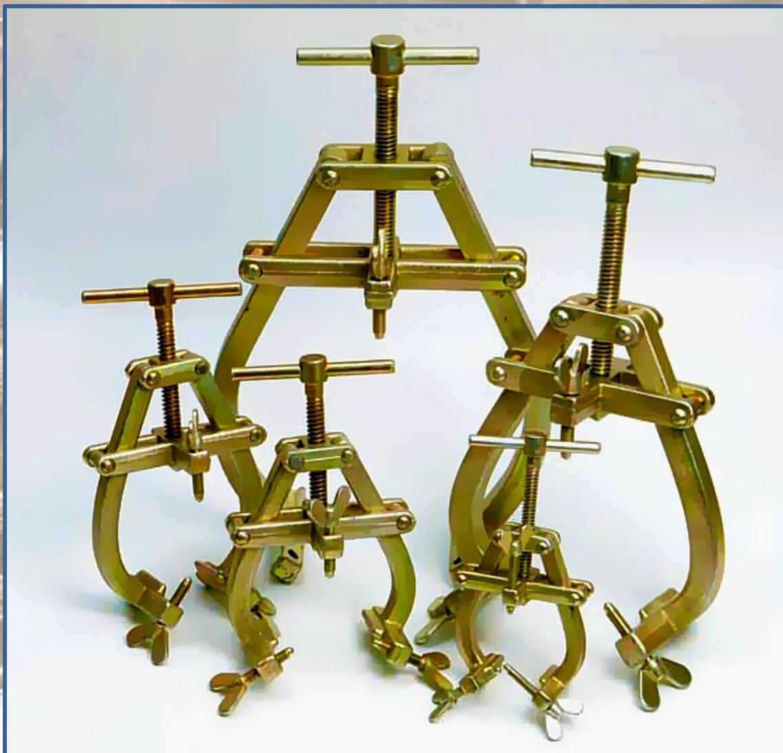
Il robusto accoppiatore a morsetto EMZ è progettato per l'unione tra tubo-tubo, tubo-curva e tubo-flangia. Ha una struttura robusta ed affidabile in acciaio galvanizzato che tramite un posizionamento rapido e sicuro permette di lavorare con facilità ed agilità su tubi con diametri compresi tra 1 e 14". Le viti di regolazione assicurano un serraggio stabile e che non danneggi il tubo.
